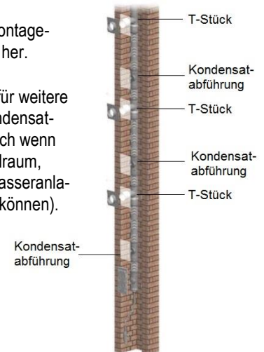
Abb. 5, Montageöffnungen für weitere Feuerungsanschlüsse und Kondensatabführungen
