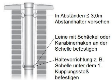
Abb. 11, Rohrelemente im Schacht ablassen
