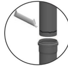
Bild 3: Untere Steckenden der abgasführenden Rohre einfetten
