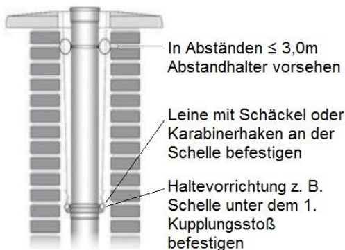
Abb. 11, Rohrelemente im Schacht ablassen
