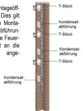
Abb. 6: Montageöffnungen für weitere Feuerungsanschlüsse und Kondensatabführungen
