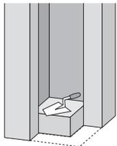
**3.** Reinigen und ebnen der Schornsteinsohle. Ggf. mit Beton oder geeignetem Mörtel die Sohle begradigen oder auffüllen!
