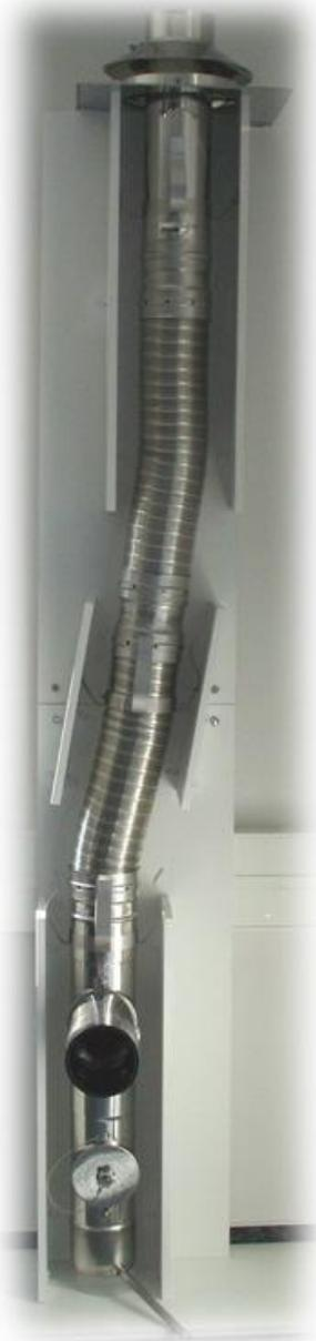
Bevor mit der Montage begonnen wird, ist der vorhandene Schacht zu reinigen und von losen Bestandteilen zu befreien. Zwischen den Innenrohren und den inneren Schachtwangen muss zur Hinterlüftung ein Mindestabstand von 2 cm bei rechteckigen sowie 3cm bei runden Schachtquerschnitten eingehalten werden.
