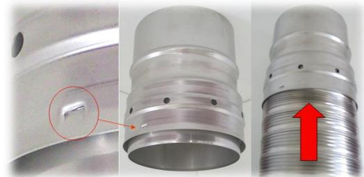
Alle Steckverbinder werden durch leichtes Drehen und gleichzeitigen Einschieben mit dem Flexrohr verbunden. Den sicheren Halt bekommt das Flexrohr durch die eingebrachten Haltetaschen, die das Flexrohr gegen das Herausrutschen sichern!
