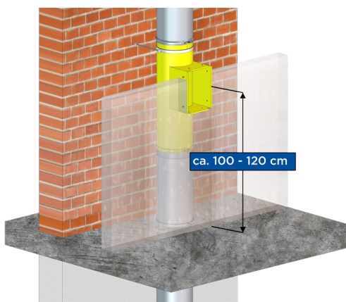
Bild 5-20: Höhe der Einwurföffnung über Fertigfußboden
